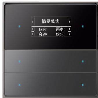
传承多功能OLED面板 (带3路继电器) 支持多种按键控制类型，可用于开关控制、调光控制、窗帘控制、场景控制、阈值控制、组合控制、空调控制、地暖控制、环境监测显示、楼梯灯定时控制、音乐控制。
