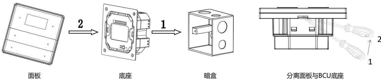
**安装:** 安装时, 手持面板边缘, 如上图面板灰色区域, 对准卡口, 垂直插入底座, 不可过分用力按压面板。
