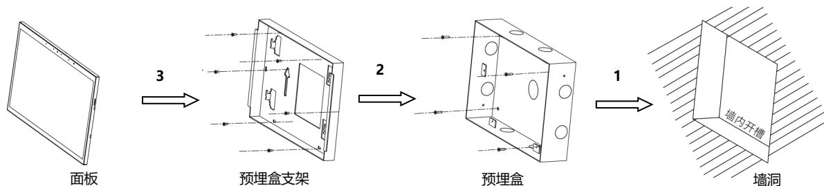
**安装：**首先使用螺丝将预埋盒固定在墙洞，再将预埋盒支架固定安装在预埋盒上，然后手持智能终端面板边缘，对准卡口放入预埋盒支架，并将面板下拉扣合固定。注意不能过分用力按压面板。
