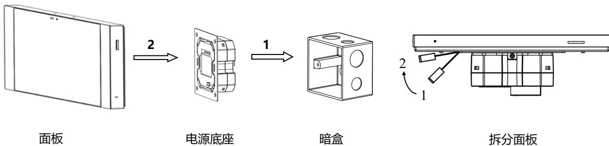
**安装：**首先将电源底座安装到暗盒上，然后手持液晶面板边缘，对准卡扣，将面板垂直插入电源底座模块，注意不可过分用力按压面板。
