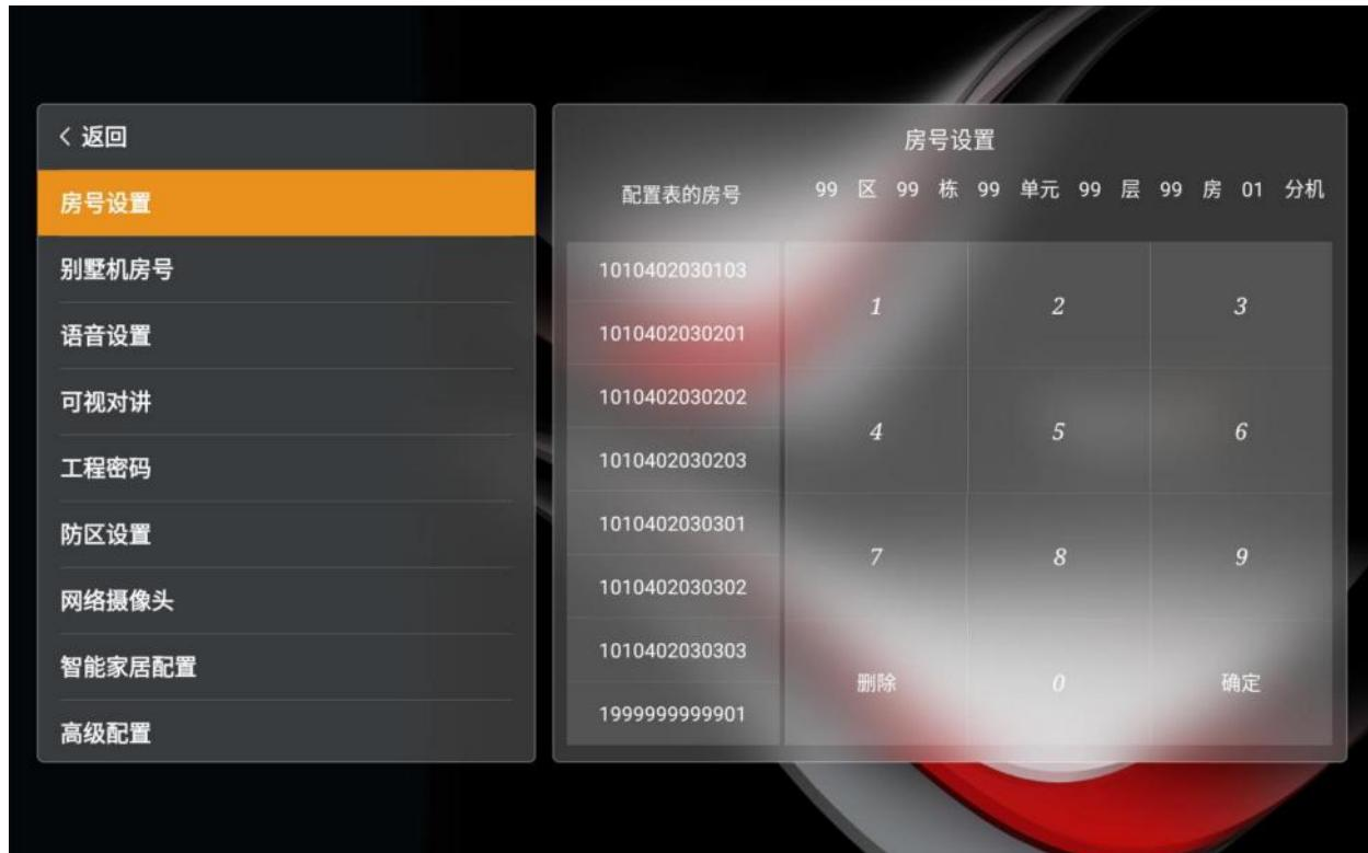
➤ 房号设置：可通过修改房号修改室内机的 IP 地址（房号通过网络配置表中获取）
