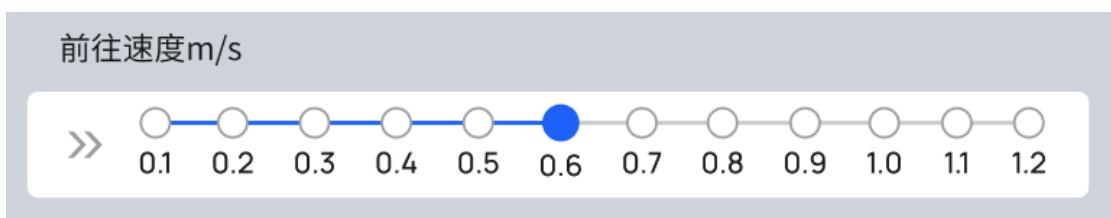
可配置机器人前往目的地的预定行驶速度，默认速度为 0.8m/s，可通过拖动光标在 0.1m/s~1.2m/s 的范围内进行调整。
