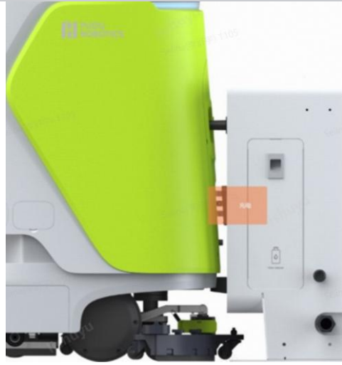
机器人与充电桩对接
