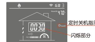
在以上界面中，时间闪烁，用户通过▲键或▼键调节定时关机时间，触摸⏻键保存同时开启定时关机功能。
