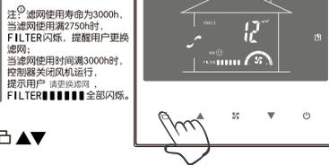
注: 滤网使用寿命为3000h, 当滤网使用满2750h时, FILTER闪烁, 提醒用户更换滤网; 当滤网使用时间满3000h时, 控制器关闭风机运行, 提示用户 请更换滤网, FILTER全部闪烁。
