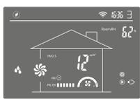
节能工作模式时, 风机按照预设的风机速度运行。
