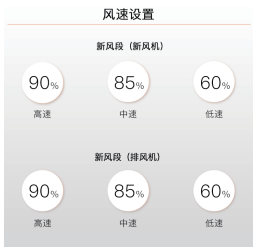
(功能设置——风速设置界面) 可设置高中低档对应风速百分比 (仅适用于直流风机)
