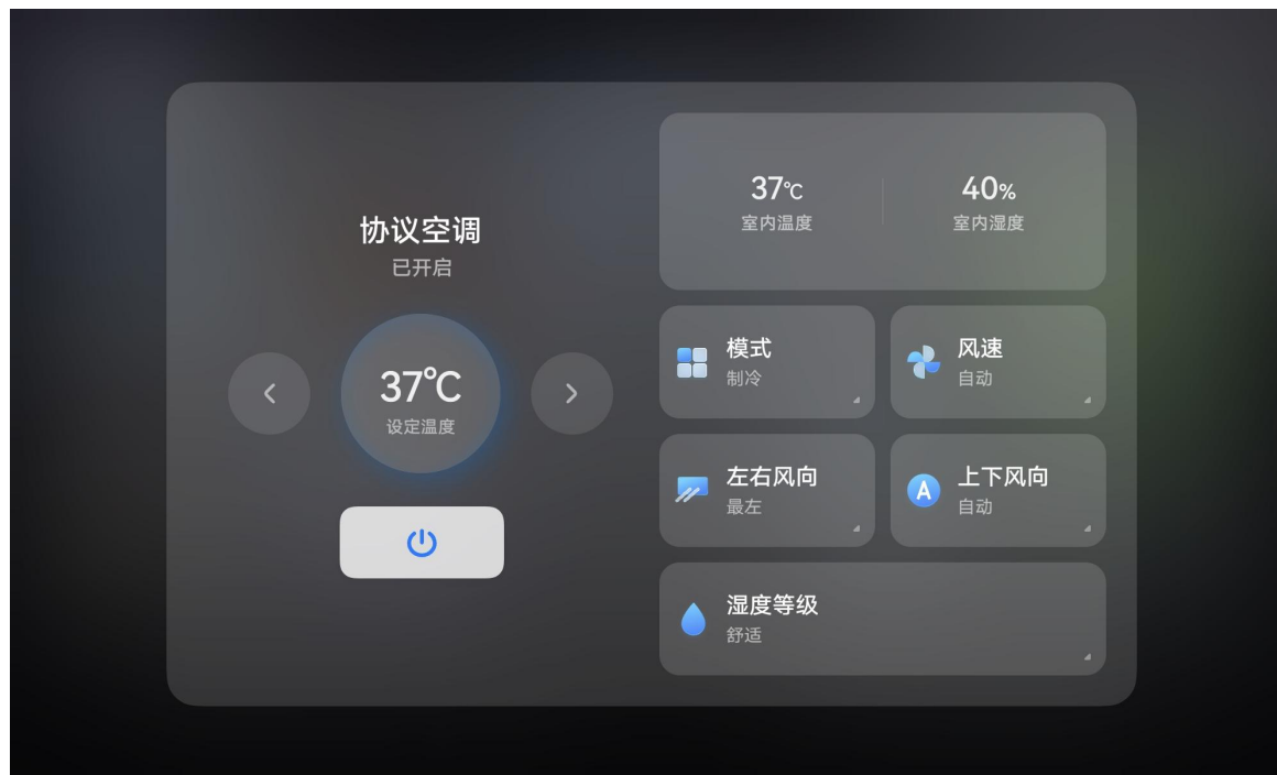
五恒房间控制（房间面板）在华为中控屏上的用户交互
