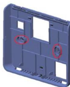
2. 将后盖安装到专用的 86 盒上(螺丝是  $\varnothing 4 \times 25\text{mm}$ );
