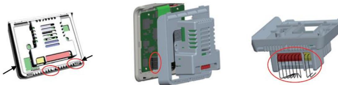
1. 从上面红圈任意一处，将后盖卡子敲开，然后保留住敲开的缝隙，并在同一侧的箭头处将后盖翘起，然后打开后盖；
