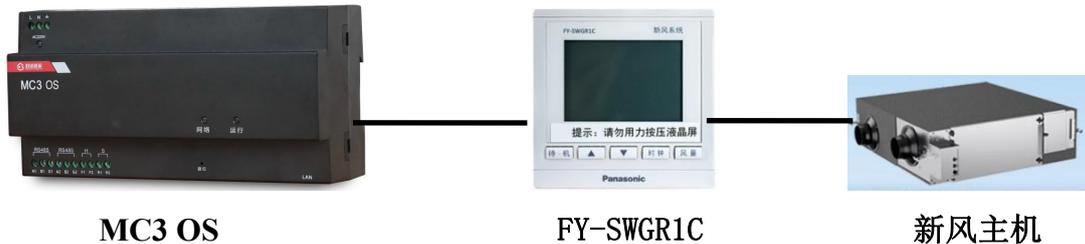
系统接线图如上，MC3OS 通信线接 FV-SWNR1C 面板，面板与新风主机正常连接。FV-SWNR1C 适用的新风型号如下：
