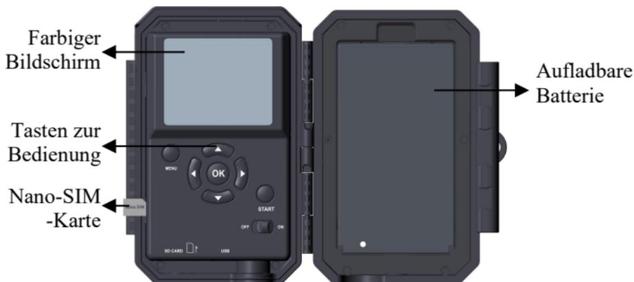
Abb. 4: Innenansicht und vorinstallierte SIM-Karte
