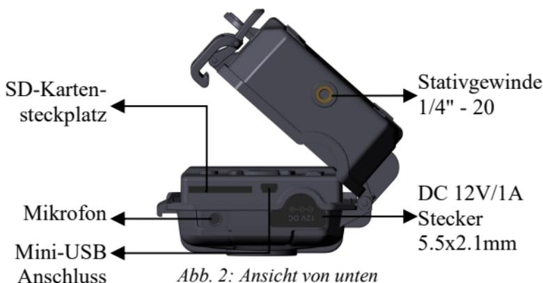
Die Kamera hat ein Loch für das Sicherheitskabel und zwei Gurtlöcher auf der Rückseite. Zur Befestigung der Kamera befinden sich auf der Rückseite zwei Gurtlöcher. Führen Sie den Gurt durch die Gurtlöcher und ziehen Sie das Ende des
