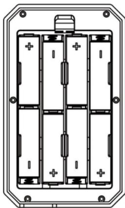
Abb. 6: Installieren der Batterien
