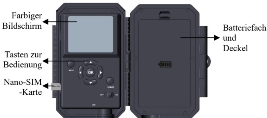
Abb. 4: Innenansicht und vorinstallierte SIM-Karte
