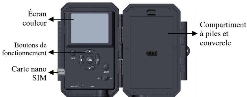
Figure 4 : Vue intérieure et carte SIM préinstallée
