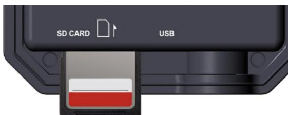
Abb. 7: Einsetzen der SD-Karte
