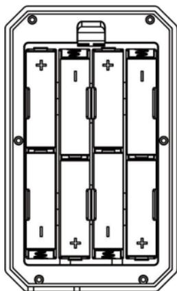
Abb. 6: Installieren der Batterien
