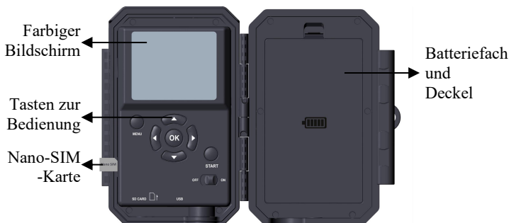
Abb. 4: Innenansicht und vorinstallierte SIM-Karte
