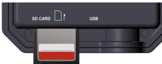
Abb. 7: Einsetzen der SD-Karte
