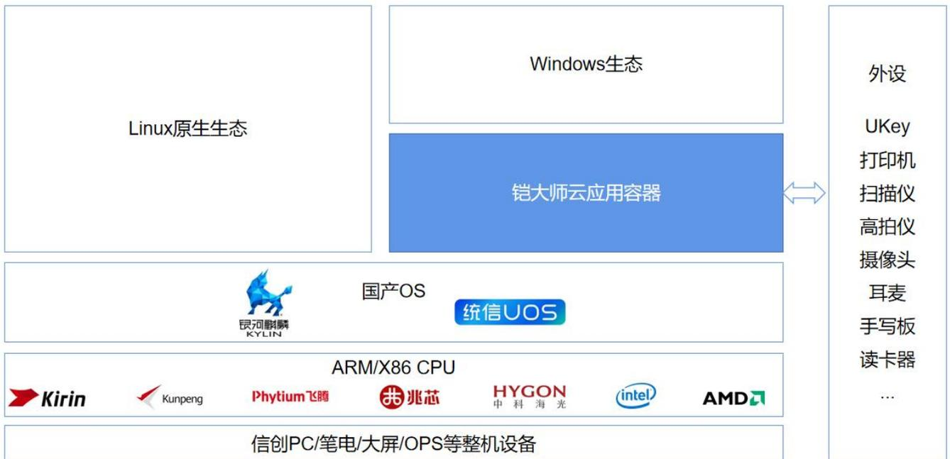
图1 系统架构
